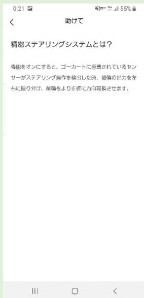
正確なステアリングを有効にするとGoKartがステアリング操作量に応じて後輪の出力を左右で変化させ、より正確に方向転換ができるように制御します。
